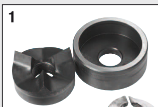
Wykonanie otworów 3-częściowych
